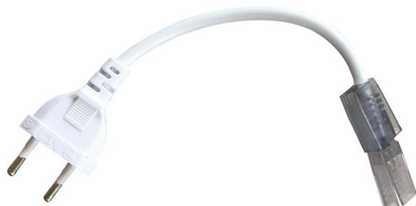
Cable rectificador que permite conectar de manera directa la tira LED monocolor SMD2835 de alta tensión a la red eléctrica de 220V directamente, sin necesidad de transformadores ni ningún otro dispositivo adicional. Cada alimentador soporta un máximo de 50 metros de tira LED a 220V con chip SMD2835 de conectores rápidos.
