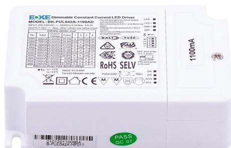
Driver multicorriente DALI dimable 42w. Regulación con protocolo DALI . Salida de corriente constante, para luminarias LED de 3-42V e intensidad entre 600ma y 1100ma. El driver incorpora filtro EMC, no produce parpadeo (NO FLICKER) y regula de forma fluida y constante la iluminación sin saltos y sin ruido.
