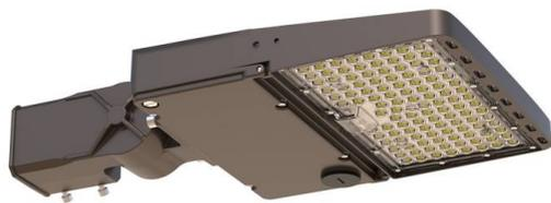
Farola de altas prestaciones con LED chip LUMILEDS de 160lm/w, Con selector de potencia 80-100-120-150W, color de luz 3000K-4000K-6000K, y regulación 1-10V. Cuerpo orientable. Equipo de alimentación electrónico IP-65 Clase I. Apertura fácil para mantenimiento.
